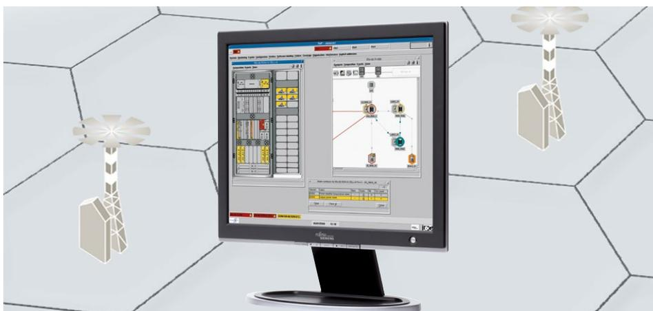
Das S-PRO Remote Access System (RAS) lässt sich je nach Kundenbedürfnis und Netzstruktur schrittweise ausbauen, von der einfachen abgesetzten Bildschirmanzeige der TMP (Technical Management Position) bis hin zur Fernüberwachung der wichtigsten Netzwerkelemente. Die Grundkonfiguration des S-PRO RAS besteht aus den zwei Elementen S-PRO RAS Server und S-PRO RAS Client.
