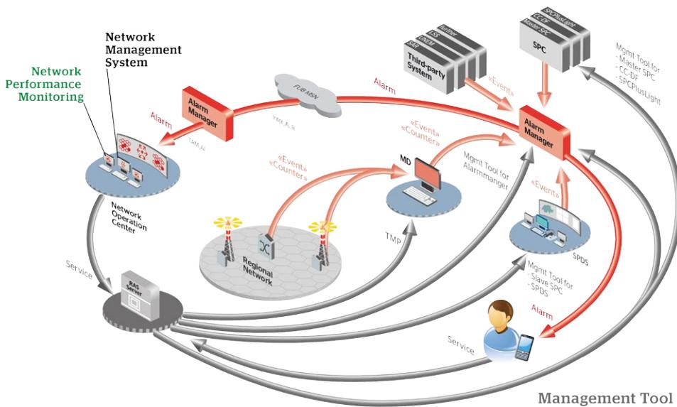
La gestion, la maintenance et la configuration de l'application TAM s'effectuent localement, et/ou à distance par le Management Tool (Mgmt Tool) via le RAS (Remote Access Service).
